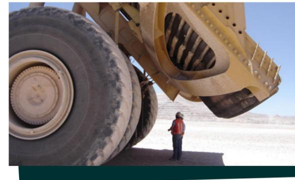
Le **Smart Tray (ST)** de Duratray est le bac à benne basculante le plus avancé pour les camions miniers et de construction. Le ST peut surveiller automatiquement son état (structurel et d'usure) et en rendre compte à l'utilisateur en ligne et en temps réel.
