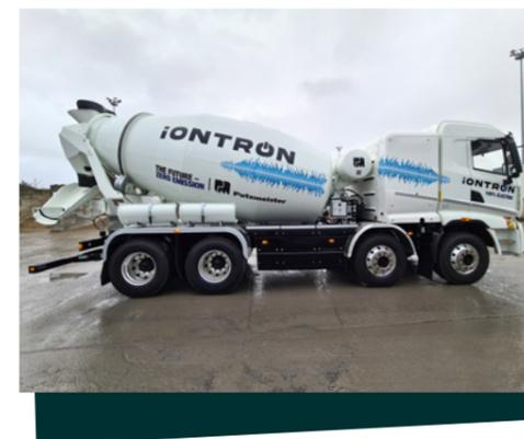
**Bétonnière portée 100 % électrique pour rouler et malaxer 100 % à l'électricité**
