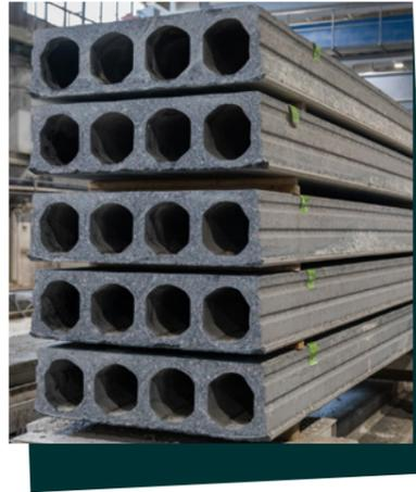
**Betolar propose un matériau de béton durable et à faible émission en carbone avec sa solution Geoprime®.** La solution proposée permet de transformer des volumes importants de sous-produits industriels précédemment inexploités, en un ciment alternative pour remplacer le ciment portland qui est responsable de 8 % des émissions mondiales de CO2. Geoprime est un matériau sans ciment destiné pour diverses applications de béton et de produits de construction.
