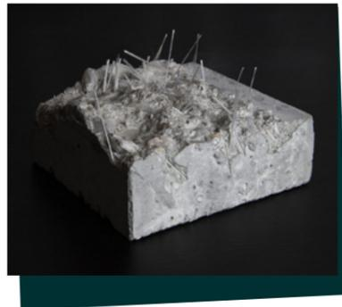
**AraNea Composite (groupe Michelin) propose sur le marché de la construction, une fibre composite verre résine, qui peut venir en substitution, de tout ou partie, des armatures présentes dans les éléments préfabriqués à partir de béton.** Notre fibre permet d'apporter des caractéristiques mécaniques et chimiques intéressantes dans le cadre de dimensionnement d'ouvrages en béton : rapport masse/poids, anti corrosion, réduction enrobage armature, adaptation au béton bas carbone.
