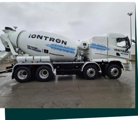
**Bétonnière portée 100 % électrique pour rouler et malaxer 100 % à l'électricité.**
