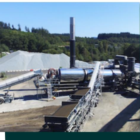
**Le TSX est une nouvelle usine d'enrobés continue, écologique, unique au monde, capable de recycler de 0 à 70 % d'agrégats d'enrobés (AE)** issus de la maintenance des routes avec un seul tambour, simplement, tout en assurant la protection de l'environnement et une haute qualité d'enrobés.
