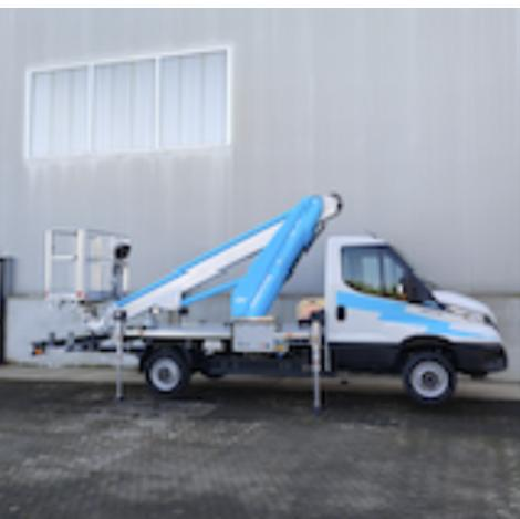
**Nacelle télescopique montée sur un camion Iveco e-Daily 35S10 Full Electric** (PTAC de 3.500 kg) présentant une hauteur de travail de 16,2 m, un déport horizontal maximal de 11,20 m avec une charge utile de 80 kg et de 7,40 m avec une charge utile de 250 kg. Longue de 7.123 mm et, fermée, haute de 2.740 mm, elle est équipée de stabilisateurs dans le gabarit, avec descente verticale avant et arrière, ce qui permet de la positionner même dans des espaces restreints.
