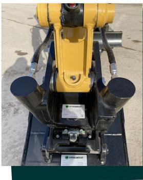
**Le TCX - une fonction d'inclinaison pour les plus petites pelles.** Disponible en montage direct avec coupleur S30/180. Nouvelle technologie sur un produit simple : Front Pin Safety Hook, Corps compact entièrement moulé, Axes d'expansion.
