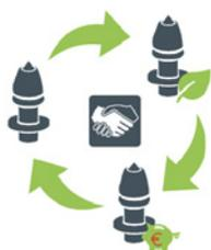
**Le procédé chimique élaboré par l'entreprise BETEK, partenaire du Groupe WIRTGEN, permet, grâce à un traitement à base de zinc, de récupérer l'intégralité du carbure de tungstène et le cobalt contenus dans les pics routiers usagés pour le réintroduire dans la fabrication de pics neufs.**
