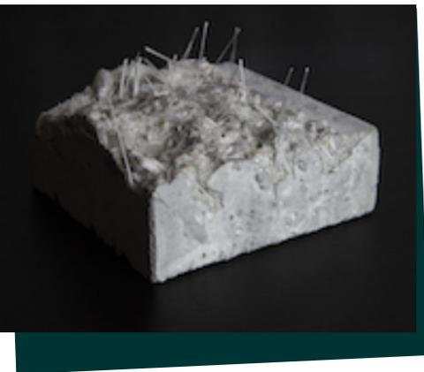
**AraNea Composite (groupe Michelin) propose sur le marché de la construction, une fibre composite verre résine, qui peut venir en substitution, de tout ou partie, des armatures présentes dans les éléments préfabriqués à partir de béton.** Notre fibre permet d'apporter des caractéristiques mécaniques et chimiques intéressantes dans le cadre de dimensionnement d'ouvrages en béton : rapport masse/poids, anti corrosion, réduction enrobage armature, adaptation au béton bas carbone.
