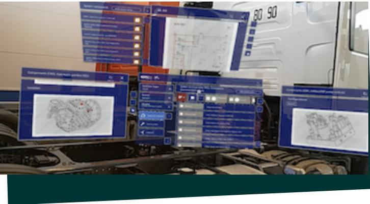
**Jaltest Diagnostics AR est le premier système de diagnostic multimarque développé dans la technologie de réalité mixte** qui permet au mécanicien de diagnostiquer les unités électroniques d'un véhicule, d'interagir avec elles, de consulter l'information technique connexe et de recevoir une assistance technique avancée, en temps réel et dans un concept de mains libres complètement innovant et pionnier sur le marché.
