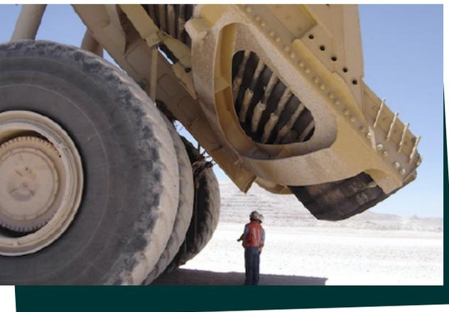
**Le Smart Tray (ST) de Duratray est le bac à benne basculante le plus avancé pour les camions miniers et de construction.** Le ST peut surveiller automatiquement son état (structurel et d'usure) et en rendre compte à l'utilisateur en ligne et en temps réel.
