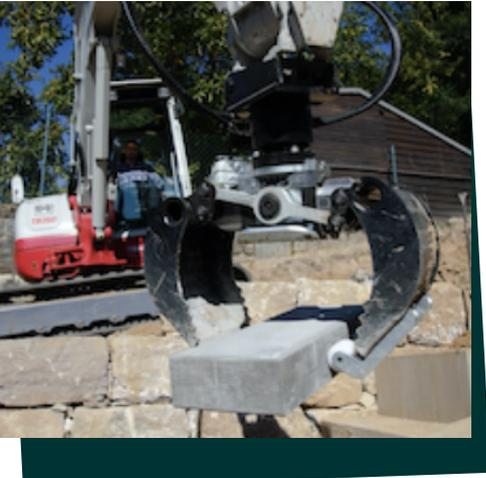
**La pince à tri SG de DMS est la première pince dotée d'un piston entièrement capoté pour le creusement et la saisie avec des excavateurs et des grues de chargement.** Sa particularité réside dans le développement du piston hydraulique à double effet breveté. La réduction du poids à vide rendue possible par la conception unique et compacte permet à toute pelle hydraulique de transporter davantage de charge utile.
