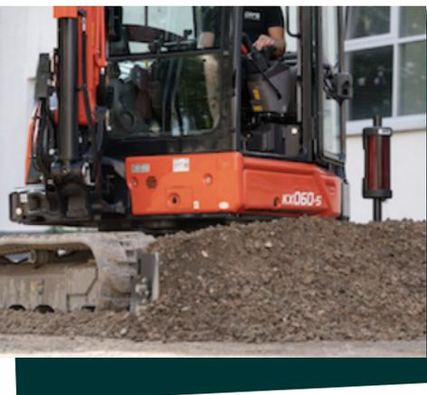
**La commande de la lame de l'excavateur (PLN) est un système de commande automatisé pour la lame de l'excavateur.**
