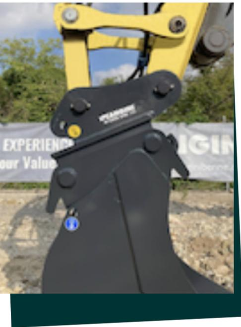
**Le système Evo est un système dont la principale valeur ajoutée est liée au concept de sécurité et d'efficacité opérationnelle conformément aux normes de sécurité EN474.** Ce système innovant permet de vérifier directement depuis la cabine l'accouplement correct attache rapide - adaptateur.
