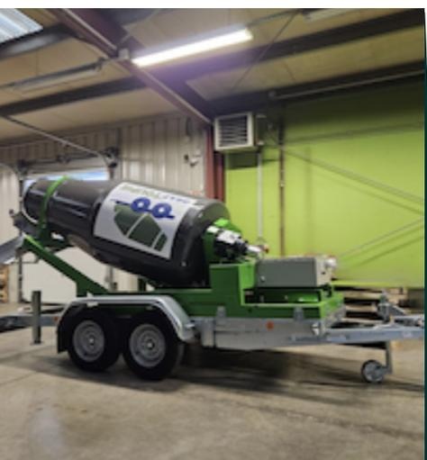
**E-SELFTOUIPIE est une mini-toupie électrique sur remorque tractable par un véhicule léger permettant de transporter des petites quantités de béton jusqu'à 1000 litres.** Adapté à la livraison des petits chantiers ou des chantiers d'accès difficile, sa motorisation électrique, lui confère une autonomie de près de 8 heures de fonctionnement.
